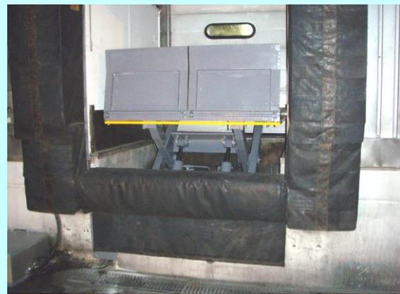
型 式: EKLPA 10-20型 (油圧ユニット別置式タイプ)
